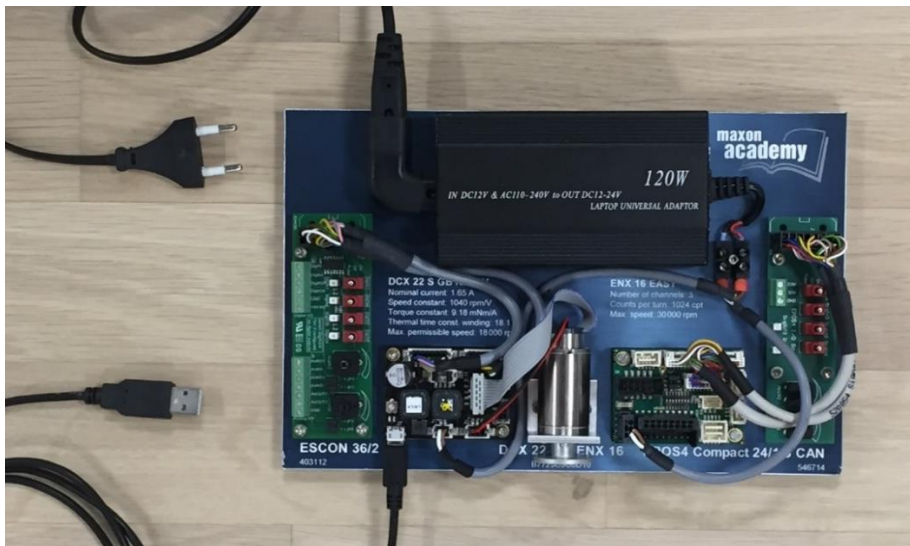
Abbildung 3: Anschliessen des ESCON Starter Kit.
