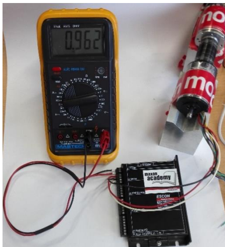
Abbildung 8 Verwenden einer ESCON als Gleichrichter. Schließen Sie die 3 Motorphasen an. Eine Stromversorgung muss nicht(!) angeschlossen werden. Am ESCON-Spannungseingang kann die vom Generator erzeugte Spannung gemessen werden.
