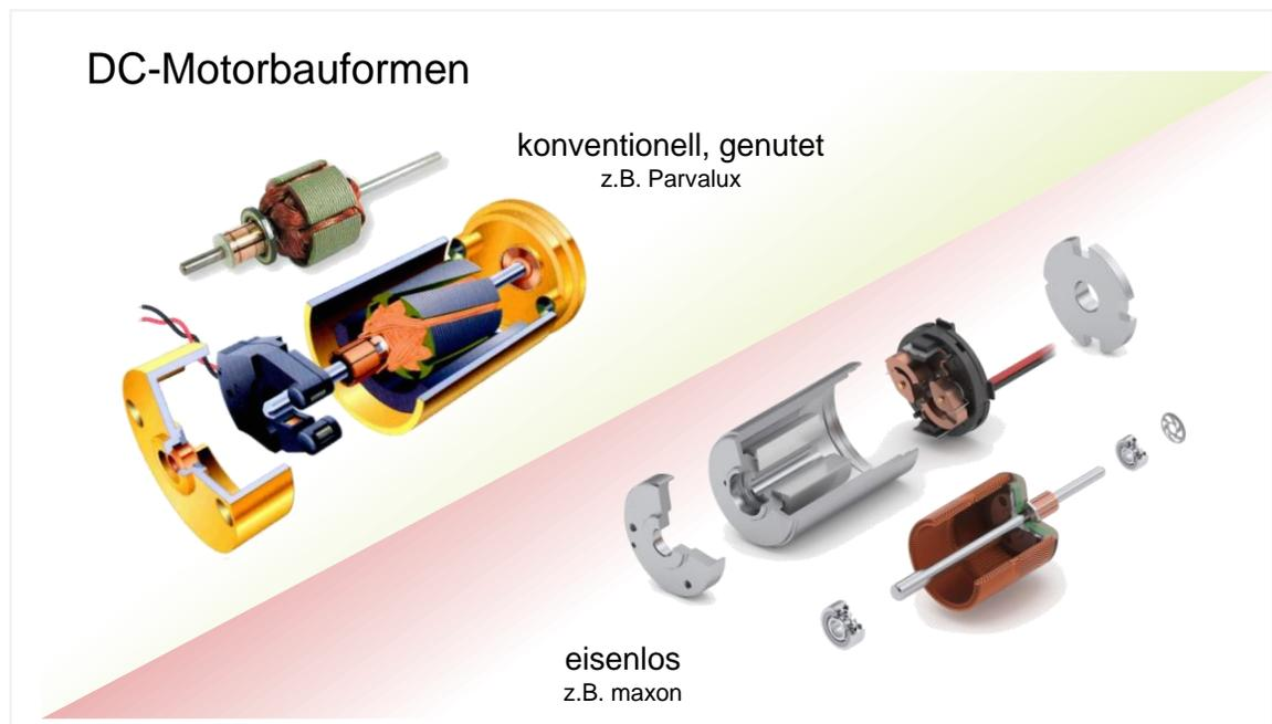
Konventionelle Gleichstrommotoren kleiner Leistung (unter etwa 1 kW) verwenden meist Permanentmagnete um das Ständerfeld zu erzeugen. Die Wicklung ist im Rotor angeordnet und meist um einem Eisenkern zur Flussverstärkung und Flussbündelung gewickelt. Gleichstrommotoren mit eisenloser Wicklung verzichten auf den Eisenkern. Dies ist das Prinzip bei maxon, das im Folgenden näher vorgestellt werden soll.
