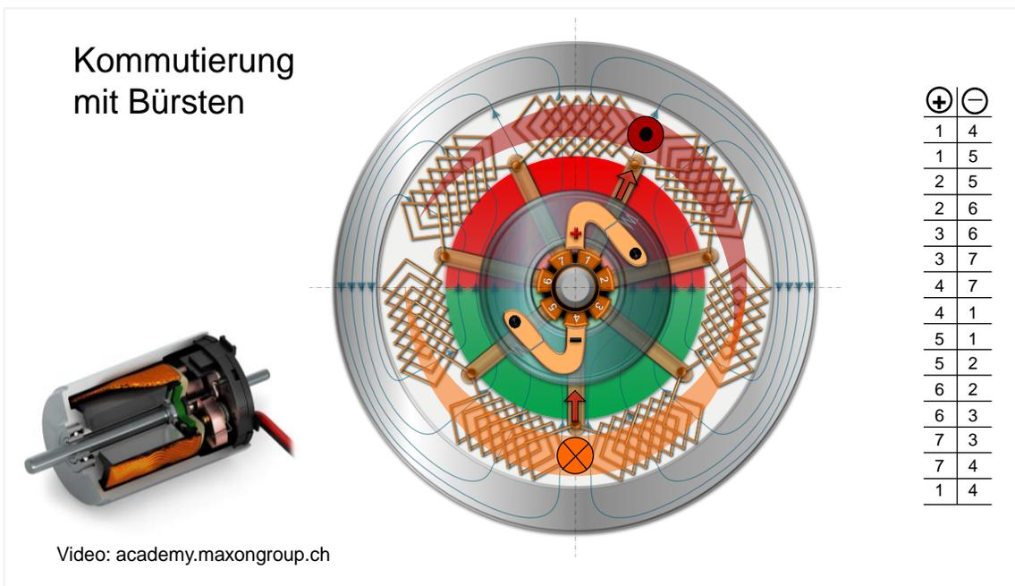
Das erzeugte Drehmoment verursacht die Drehung des Rotors und damit entfernen sich die Stromrauten von den Magnetpolen. Das Drehmoment wird schwächer, ja nach einer Vierteldrehung verschwindet es und zeigt dann in die andere Richtung.
