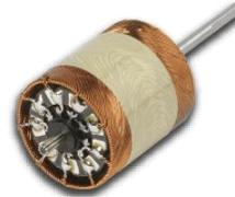
Wie wir schon gehört haben ist die Edelmetallkommutierung sehr empfindlich auf Bürstenfeuer. Diese Funken können beim Kommutierungsvorgang entstehen, wenn der Kontakt zwischen Kollektorlamelle und Bürste gelöst wird. Die Wicklung ist eine induktive Last und der Strom möchte weiterfließen. Funken entstehen aber auch, wenn bei höheren Drehzahlen die Bürste zu Schwingungen angeregt wird und die Bürste kurzzeitig abhebt.
