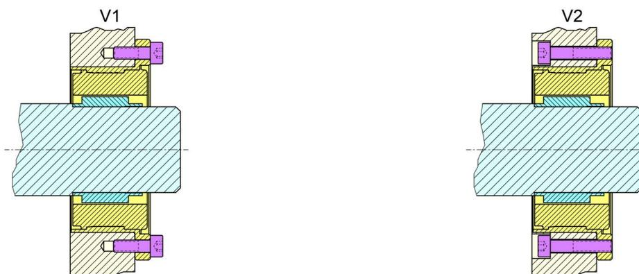
Abbildung 3-5 Stator montieren
